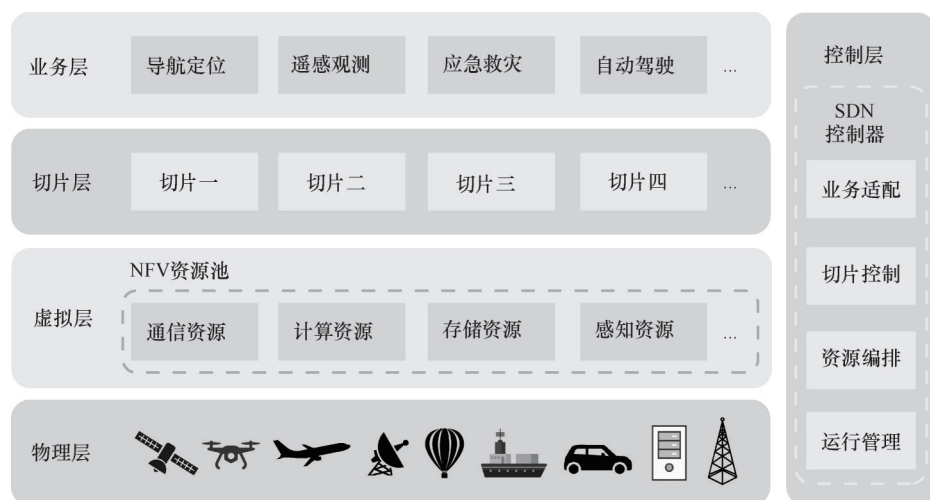
图2 网络切片逻辑功能架构
